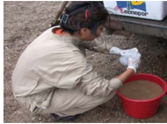
La Ing. Lucy Romero realiza la homogenización y distribución de la muestra
