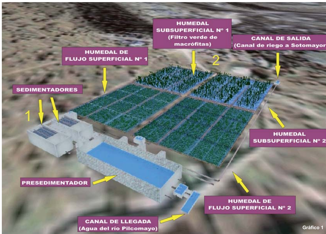
Gráfico 1: Imagen en 3D de la Planta de abatimiento de metales pesados y del humedal artificial.
