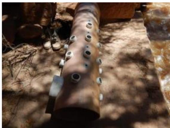
**Fotografía 1 y 2. Vista de los tubos concéntricos de protección de la sonda y de los orificios laterales, respectivamente.**
