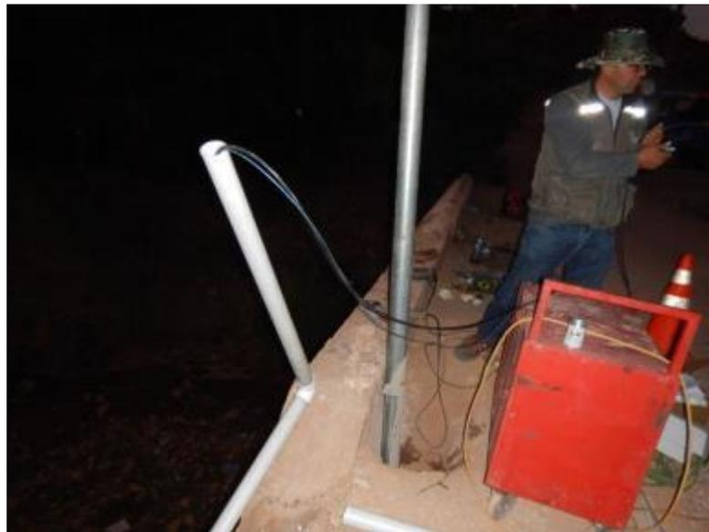
*Fotografía 11. Caño de protección del cable de campo de la sonda YSI.*
