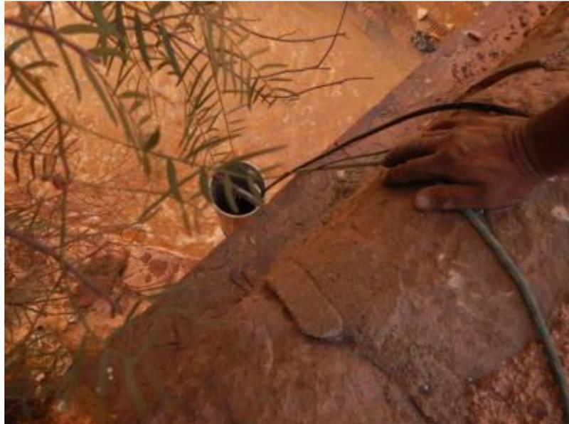
*Fotografía 10. Sonda YSI colocada.*
