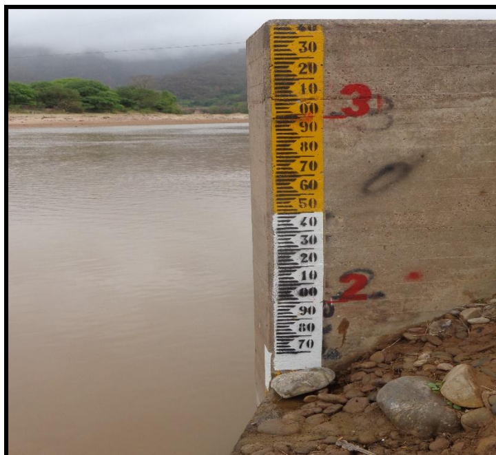
Fotografía N° 3: Escalas aguas bajas
