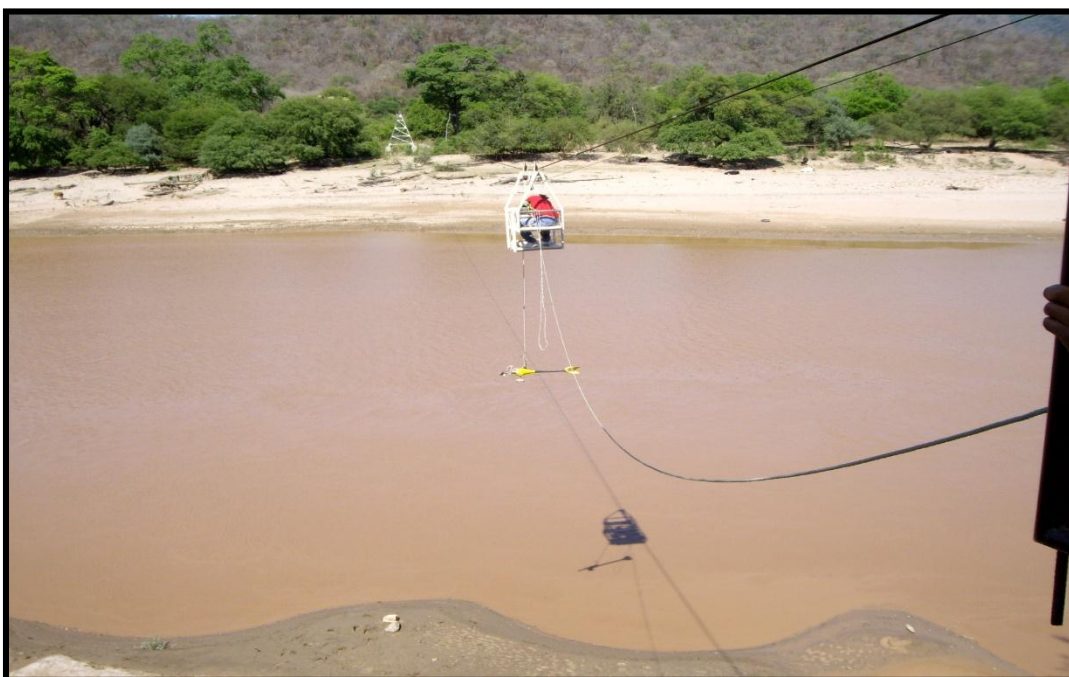
Fotografía N° 2: Personal de SENAMHI aforando (vista desde margen izquierda)
