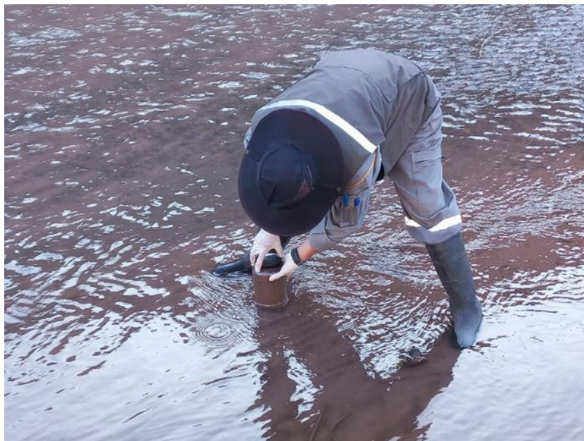
Fotografía 27. Toma de muestras de sedimentos de margen derecha
