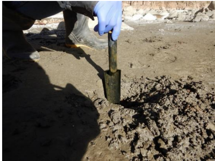
Fotografía 42. Altura del espesor superficial color gris (10 cm)
