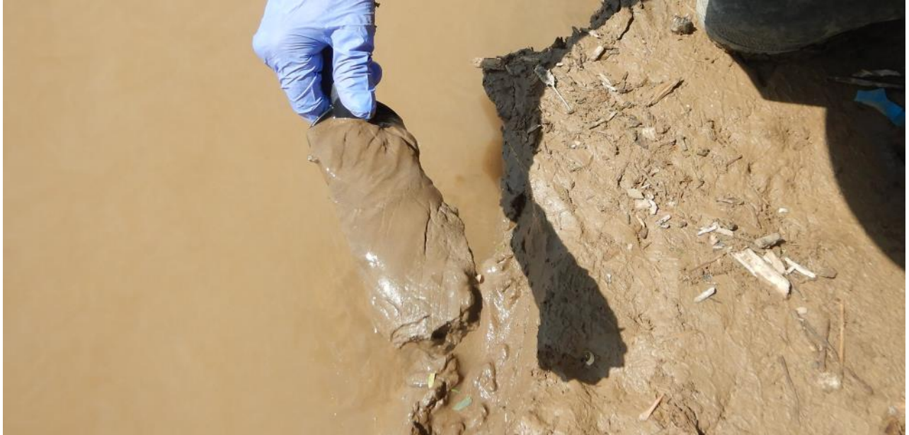
Fotografía 3. Toma de muestra de sedimento de margen derecha
