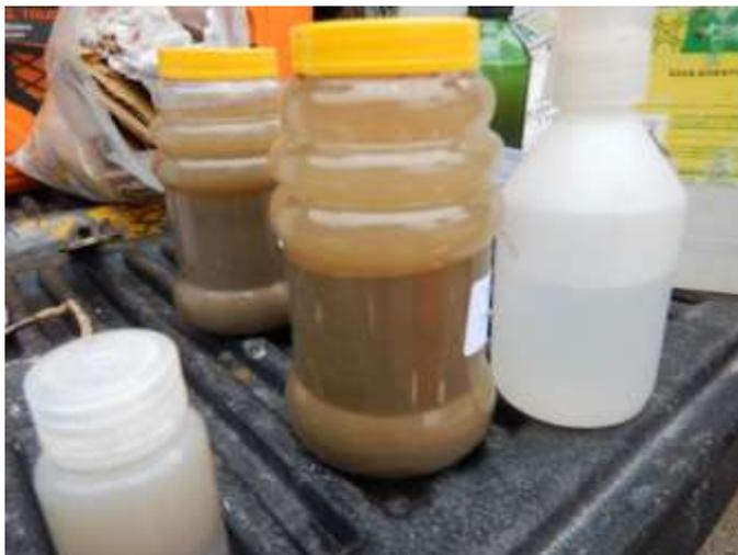
Foto 16. Muestra de agua sedimentada en el Río Tumusla (Tumusla) – se observa el volumen del sedimento de casi la mitad del frasco de muestreo.
