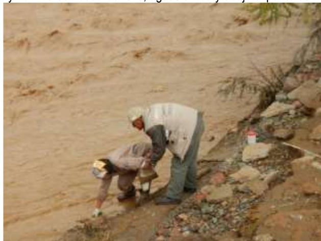
Foto 29. Muestreo de sedimentos del margen izquierdo.
