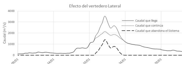
**Fig. 11.** Efecto del vertedero lateral en la modelación 1D.
